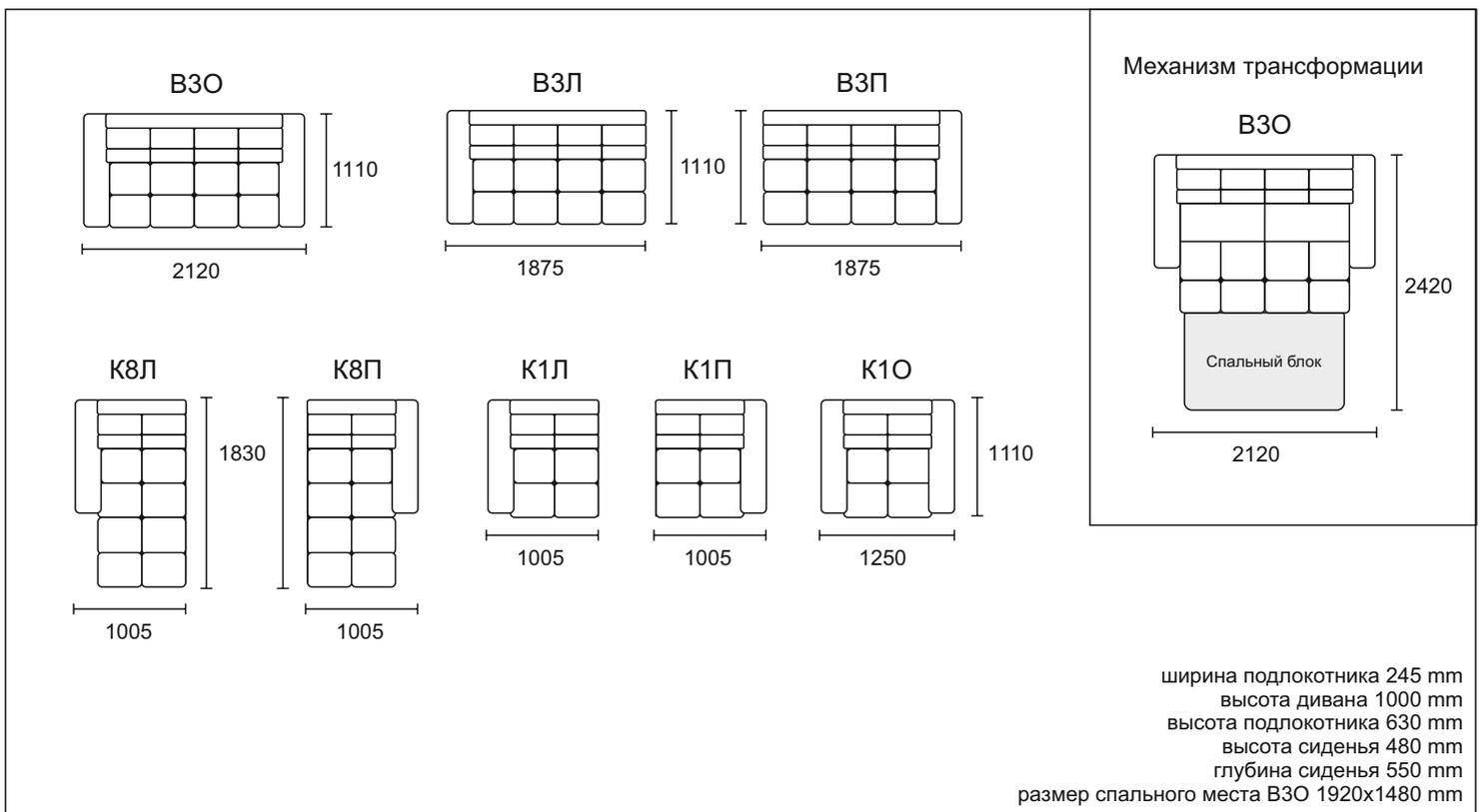
Согласно ГОСТ 19917-2014: для мебели, габаритные размеры которой определяются размерами мягкого элемента, предельные отклонения от габаритных размеров не должны превышать +/- 20мм.
